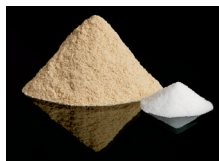
Composite = 6 volumes de particules de bois + 1 volume de poudre de polymère
